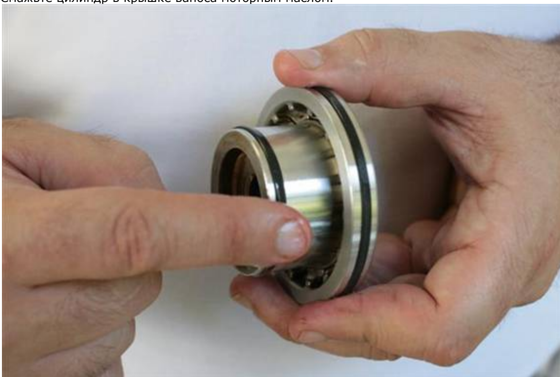
Смажьте маслом маленькое тефлоновое кольцо на поршне и поверхность возле него.
