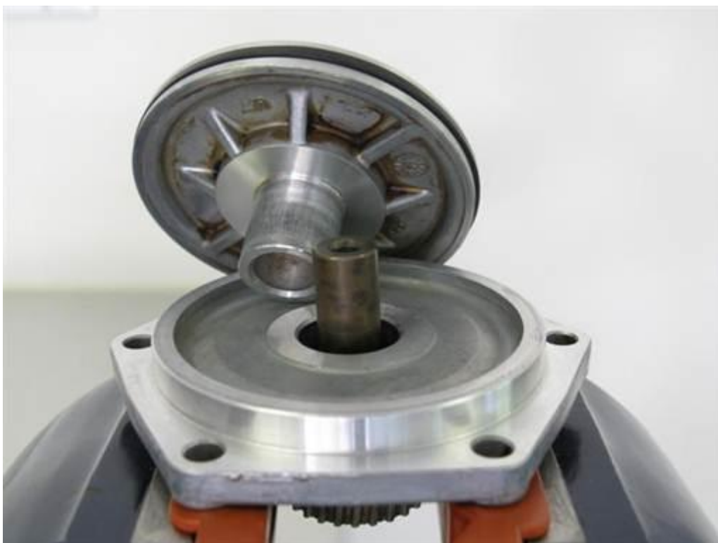
Снимаем поршень с оси шестеренки.
