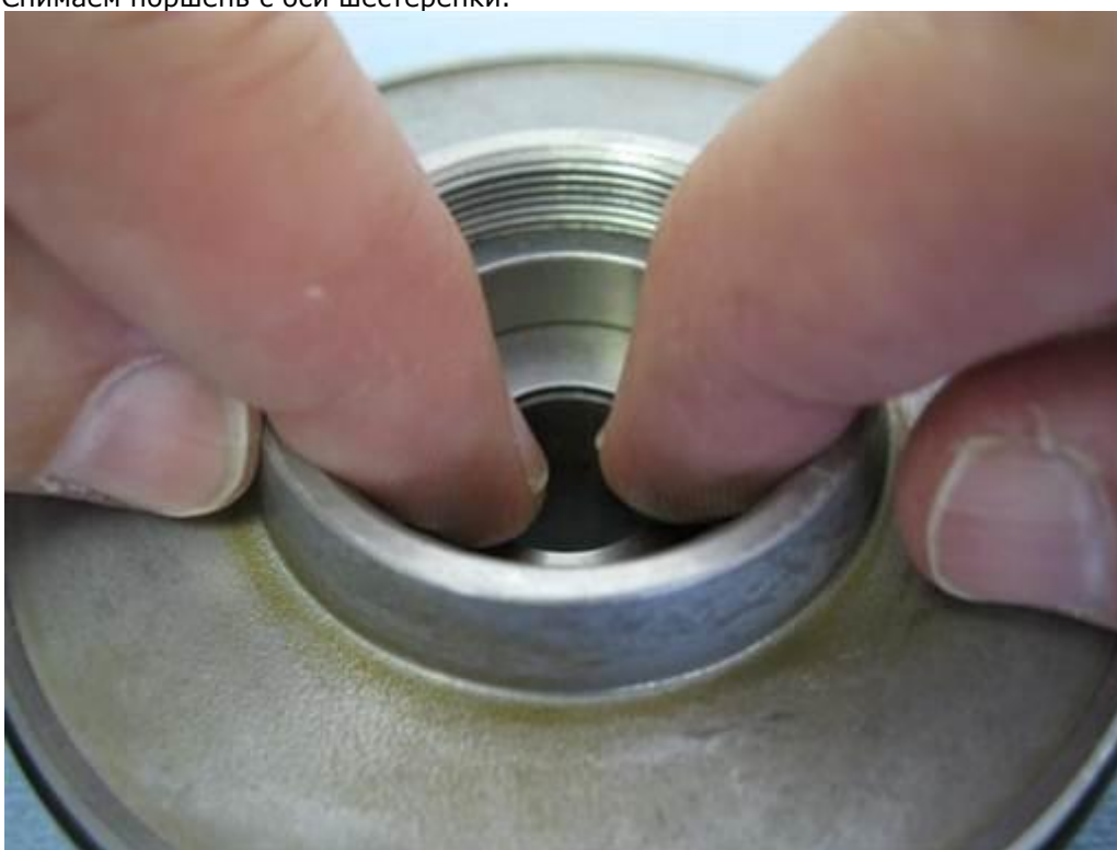
Снимаем поршень с оси шестеренки.
